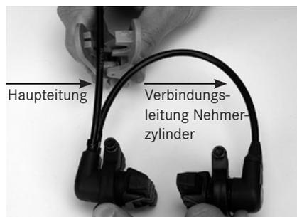
Hauptleitung mit Hilfe des Leitungsschneiders in der Nähe der Nehmerzylinder auf gewünschte Länge kürzen.
