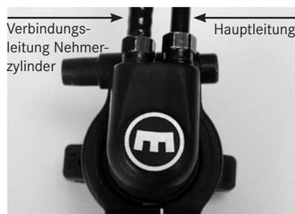
Wichtig! Die Leitung muss **bis zum Anschlag** in den Zylinder geschoben und während des Festschraubens mit 8mm Drehmomentschlüssel nach unten gedrückt werden.
